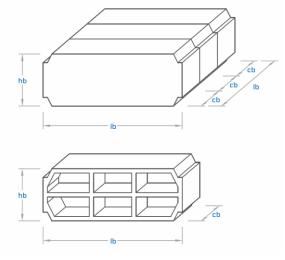
Nota: As dimensões indicadas têm uma tolerância de +/- 5 mm.
